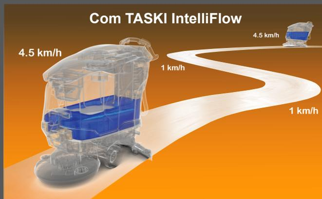
O sistema patenteado TASKI IntelliFlow fornece a quantidade correta de produto de limpeza e água ao pavimento dependendo da velocidade da máquina, aumentando significativamente o rendimento por m<sup>2</sup> por tanque. À medida que o operador abranda, o sistema avançado ajusta-se em tempo real para utilizar menos solução, diminuindo o consumo de água até 50%, reduzindo o tempo em que o tanque é consumindo, evitando os reenchimentos e baixando os custos.
